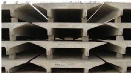
图2 双T板预制构件
