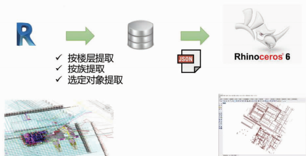
图 11 基于工具 API 的 BIM 数据交换
