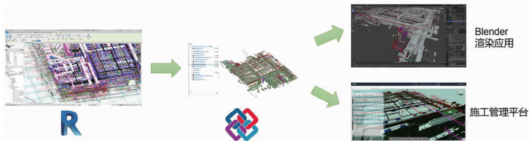
图 10 基于 IFC 的 BIM 数据交换
