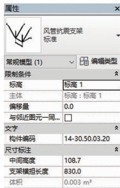
图 7 风管抗震支吊架
