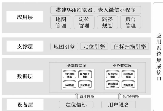
图2 导航系统总体架构图
