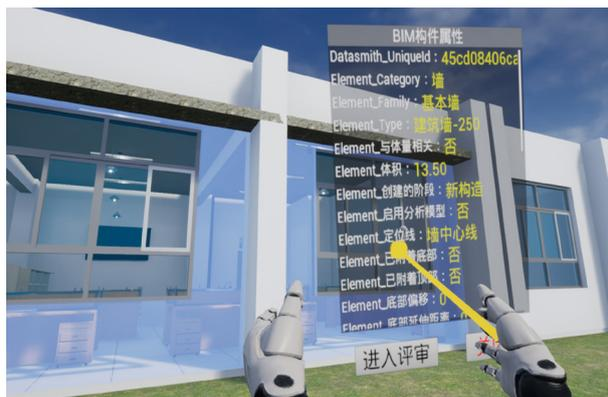
图3 通过手持控制器点选构件并展示BIM属性
