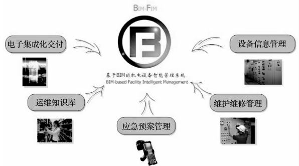
图 1 BIM-FIM 2012 系统的功能模块组成
