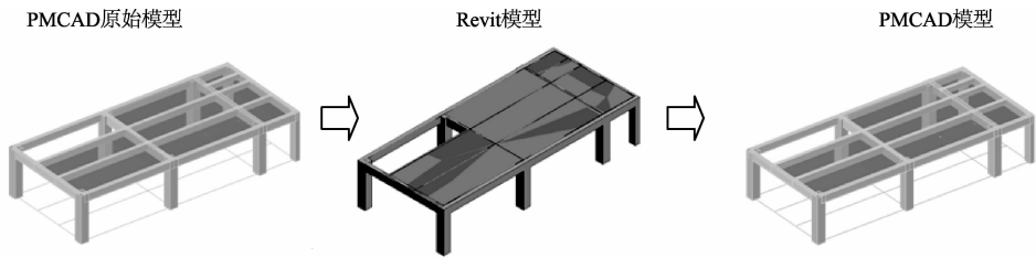
图3 带有偏心的模型转换
