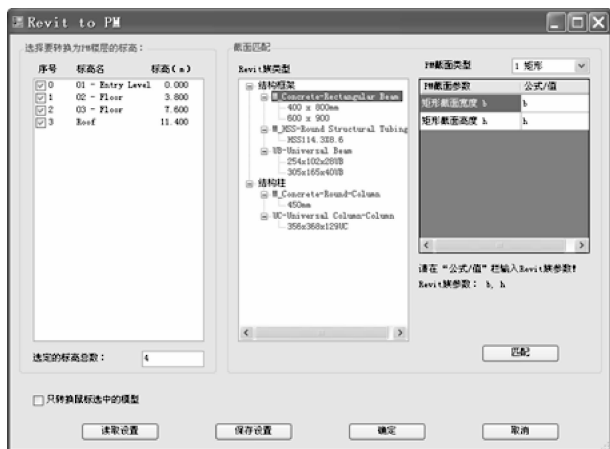
图 2 Revit 模型转 PKPM 设置
