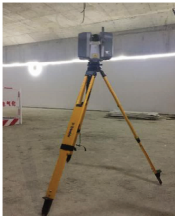
图 7 天宝 TX8 三维激光扫描仪
