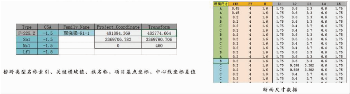
图 8 桥跨结构 Excel 数据表
