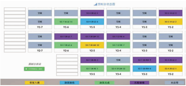
图 7 台座施工状态颜色显示
