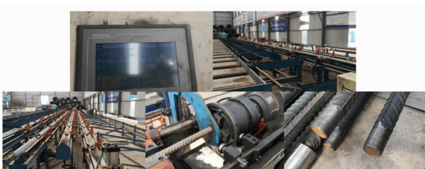
图 10 钢筋套丝智能化生产线
