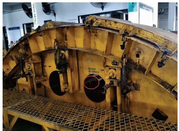
图 5 模具钩挂 RFID 标签
