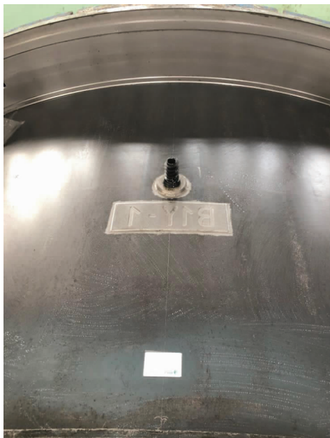
图 3 脱模剂涂抹后粘贴标签
