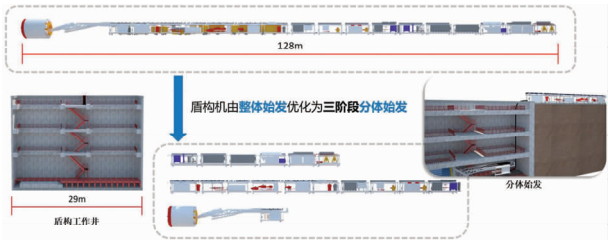
图 10 狭小盾构井盾构机优化分体
