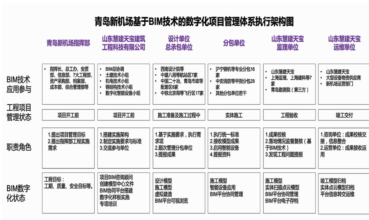
图 2 BIM 数字化项目管理体系架构图
