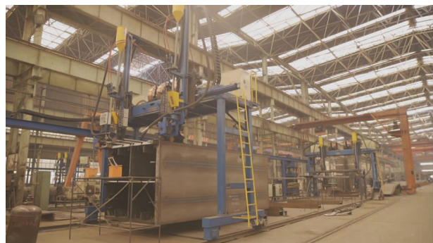
图 20 智能焊机焊接场景
