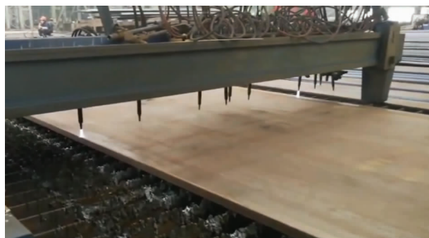
图 13 钢结构构件下料切割
