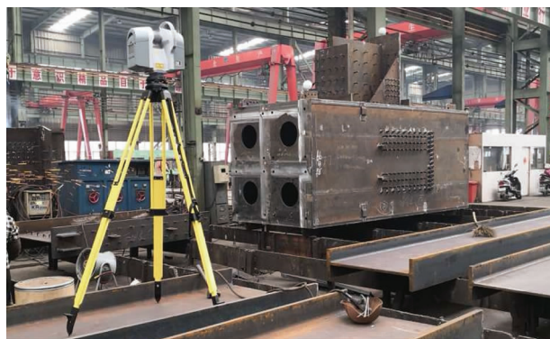
图 30 钢构件现场扫描
