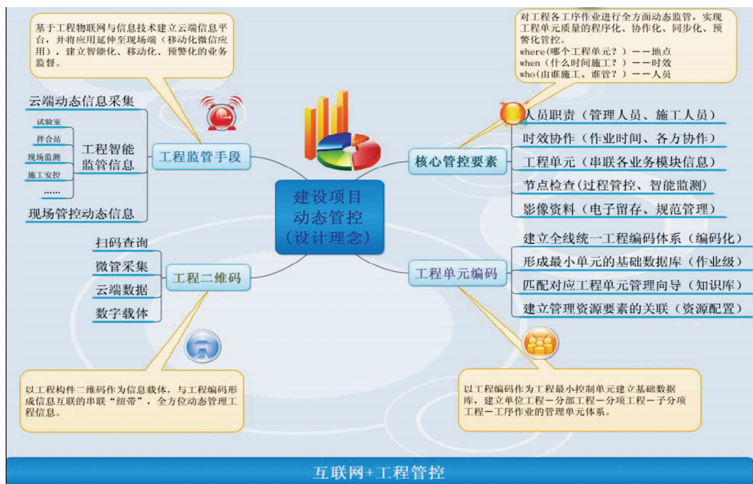
图1 “智慧工地”设计理念及总体架构
