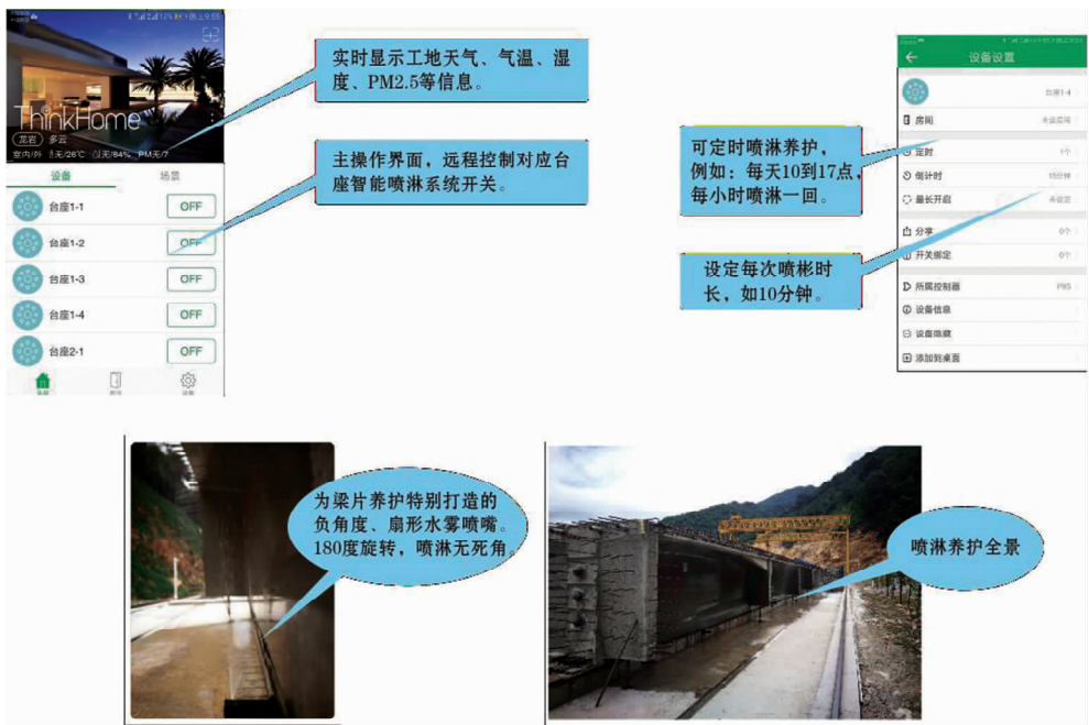
图8 梁片智能养护云控系统
