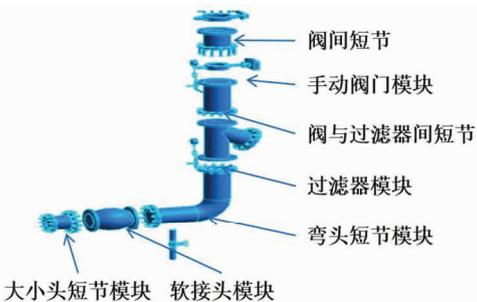
图 8 多个构件拼装成的小模块
