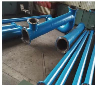
图6 在工厂预制完成的管道模块
