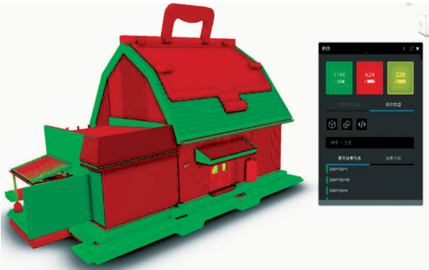
图 6 竣工模型相对与施工图模型的不同
