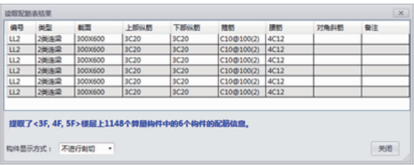
图 9 连梁配筋明细表读取结果
