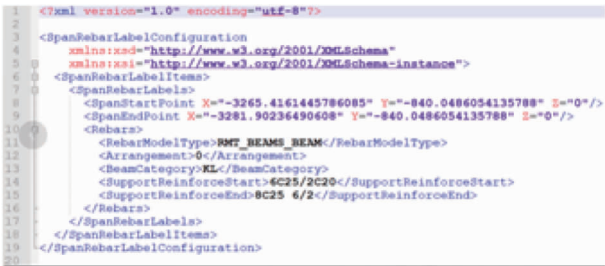
图 6 支座负筋配筋信息记录图
