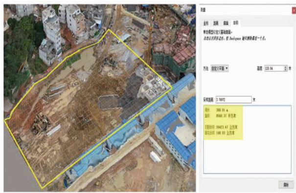
图 4 计算场地面积、土方挖填等数据
