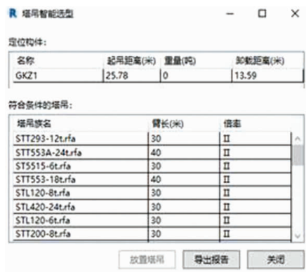
图 4 BIM 辅助大型施工机械选型
