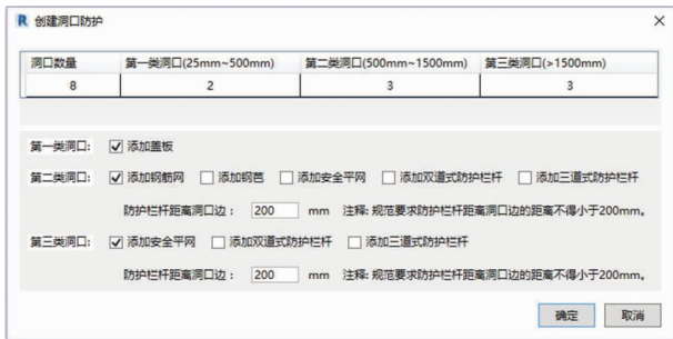
图7 水平洞口的智能识别与临边防护措施的自动创建
