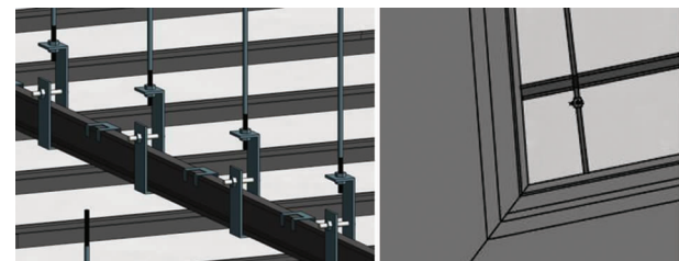
图 9 吊顶工程精细化建模
