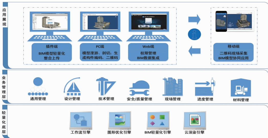
图1 中建八局 BIM 协同管理平台的总体架构设计
