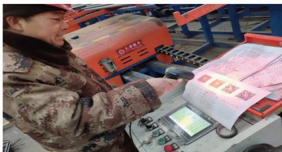
图 8 输出钢筋下料二维码并扫码加工
