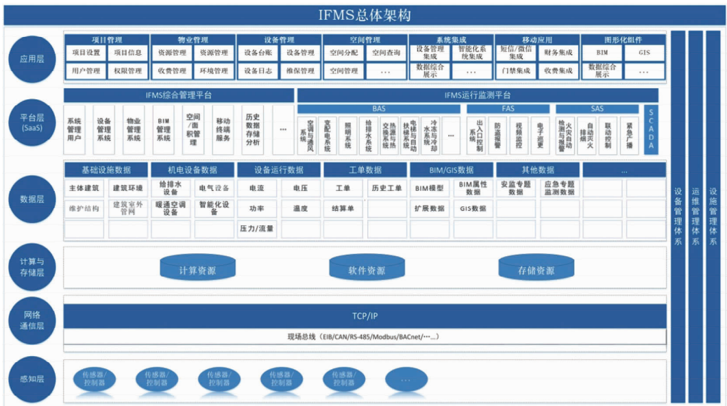
图3 IFMS 系统多层结构
