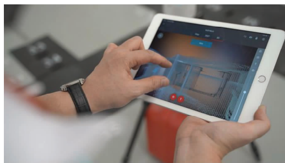
图 4 工程师在现场检查三维激光扫描生成的点云模型
