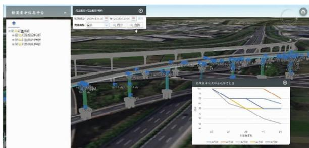
图10 维修后桥墩技术状况评分变化趋势图
