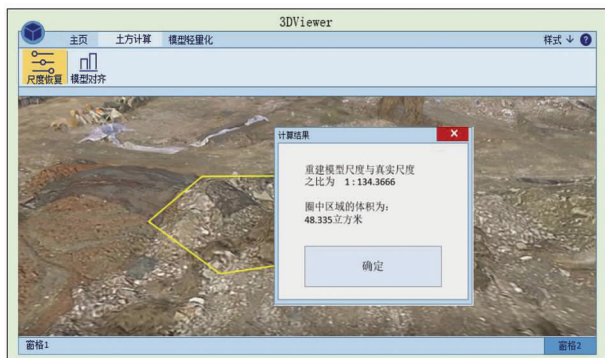
图3 三维实景土方量计算示意图
