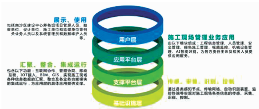
图2 智慧工地系统架构
