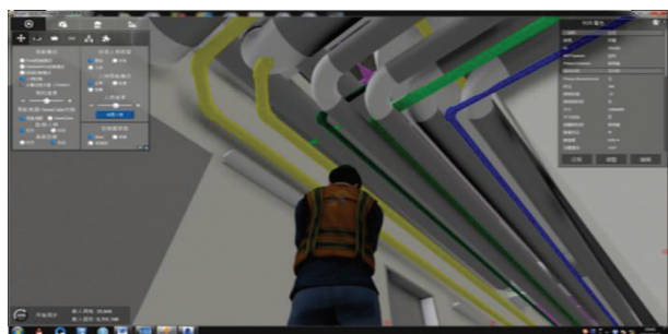
图 4 FUZOR 检测碰撞图
