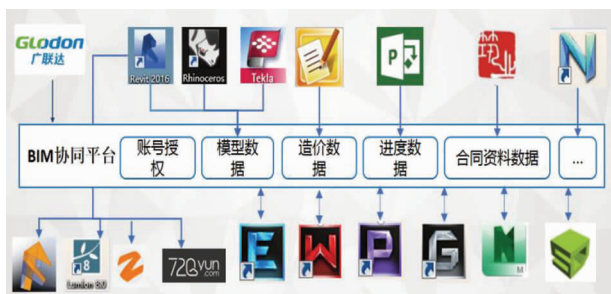
图 2 软件应用流程
